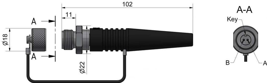
Alle Abmessungen in [mm]; Toleranzen nach ISO 2768 m-H
