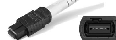
**Câble surgainé** OM4 16 fibres, diamètre câble 3,0/4,5 mm, FRNC-LS0H, polarité : TIA méthode B « 1 vers 16 »
