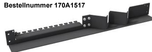
Z-Blech mit 2 PreCONNECT® Vierkantschnittstellen rechts, Kabelabführung nach innen. Universelle Abfangung von Kabeln mittels Kabelbindern links. Bestellnummer 170A1517
